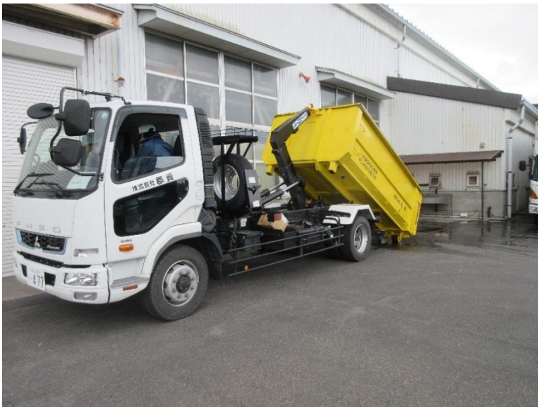
コンテナの脱着作業
